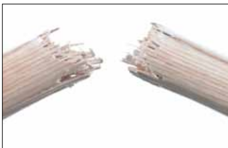
Standardstiele aus Eschenholz haben kurze Fasern. Bei einem Fehlschlag bricht der Stiel – der Hammerkopf fliegt unkontrolliert weg.
