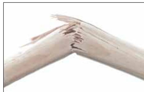
Das Hickory-Holz der Stiele des SecuTec®-Hammers hält durch seine langen Fasern den Stiel auch bei einem Bruch noch zusammen.
